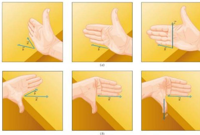
Ilustração da regra da mão direita para produtos vetoriais. (a) Empurre o vetor  $\vec{a}$  na direção do vetor  $\vec{b}$  com os dedos da mão direita. O polegar estendido mostra a orientação do vetor  $\vec{c} = \vec{a} \times \vec{b}$ . (b) O vetor  $\vec{b} \times \vec{a}$ , tem o sentido oposto ao de  $\vec{a} \times \vec{b}$ .
